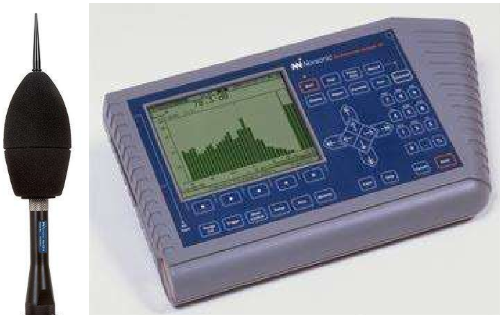
118 pav. Triukšmo lygio matavimams naudojamas skaitmeninis garso analizatorius Nor121.
